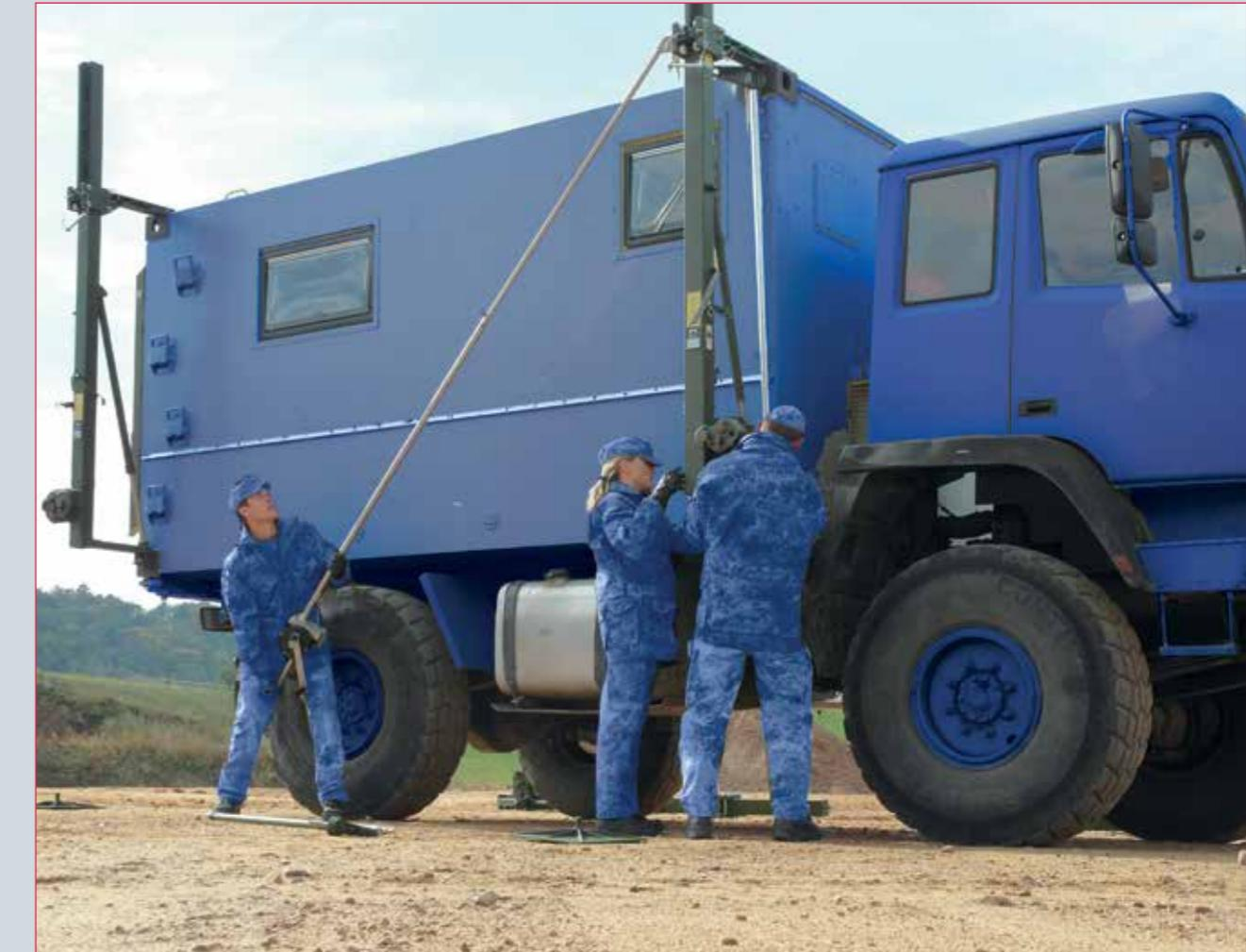
**Die Montagewinde dient als Anbauhilfe für den Anbau einer Hebevorrichtung am Container.
